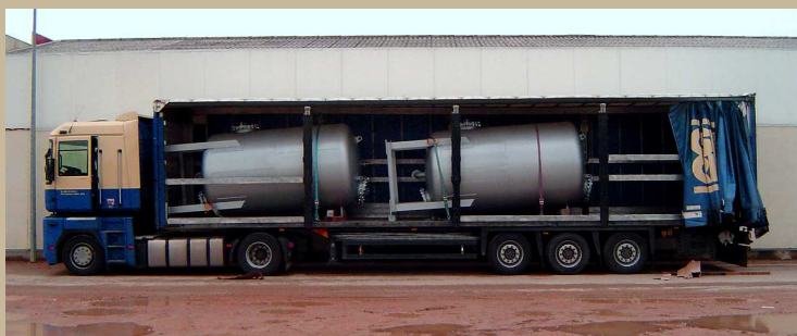
Filtros de capacidad 7,5 m 3 para el tratamiento de agua
